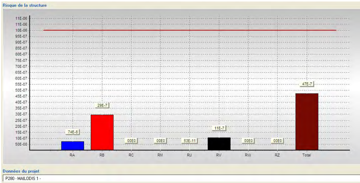
Figure 2 : Calcul du risque R1 (avec protection)
